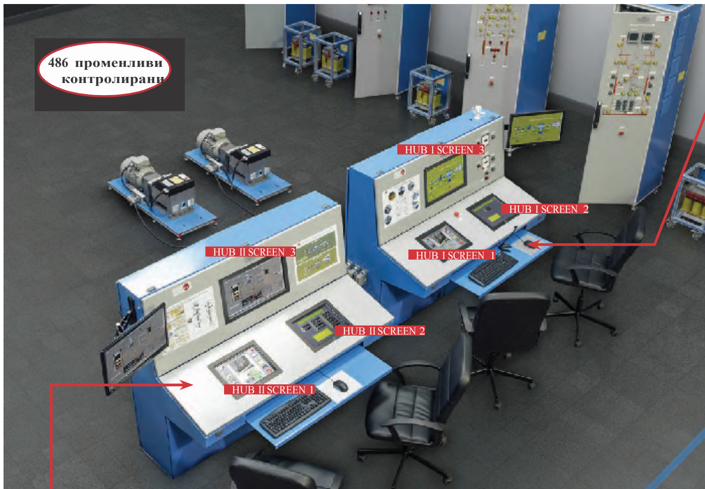
Механична Енергийна Система със SCADA II
