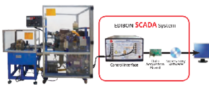
TBMC75 Изпитателен стенд за четирицилиндрови двигатели, 75 kW с компютърно у-ние
