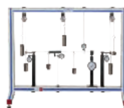
MDLE Модул за изучаване методи за определяне линията на еластичност
