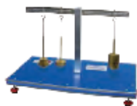
MEMB2 модул за изучаване равновесието на моментите при двуръчен лост
