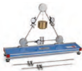
MFBS Изучаване на силите в структурата на обикновен лост
