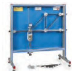
MFCS3 Модул за изучаване на деформация при фермите
