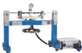
MFGE Определяне на коефициент на калибриране на тензодатчик
