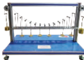
MFCS1 Изучаване на силите при различни единични ферми
